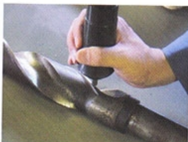
● 钻头的刀口的硬度测量
